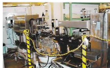
図2 偏極中性子反射率計SUIRENの外観
