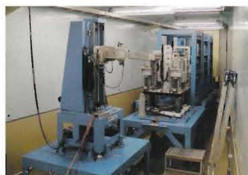
図2 試料水平型中性子反射率計ARISA-IIの外観
