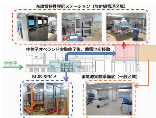
図 2. BL09 SPICA 周辺に隣接されている充放電特性評価ステーション (放射線管理区域) および蓄電池実験準備室 (一般区域)。
