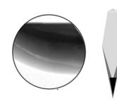
図10. 刃先の透過像(左) と造込み(右) [18]
