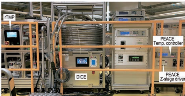
図2 BL02分光器上に常設されたrTMP[5], DICE[4]の制御パネルとPEACEと名付けた自動試料交換機[4]の関連制御機器
