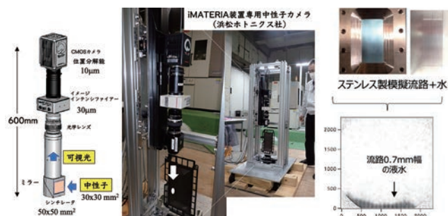
図13 iMATERIA装置専用の中性子カメラ(左)。解像度100 \mu mで数センチ角の画角を目指す。模擬燃料電池の観察例。0.7mm幅の流路と水を可視化した実測例(右)。
