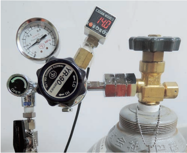
図3 Heガスの一次圧を取得したデジタルレギュレタシステム [6]
