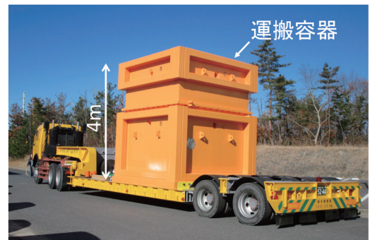
図2 100トントレーラーによる使用済み水銀ターゲット容器の輸送
