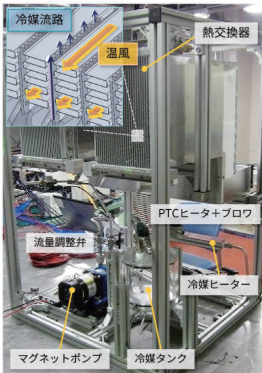
図1 車載エアコン模擬実験装置の外観
