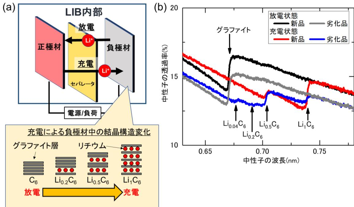
図 1 (a) LIB 内部と負極材の結晶構造変化の模式図、
